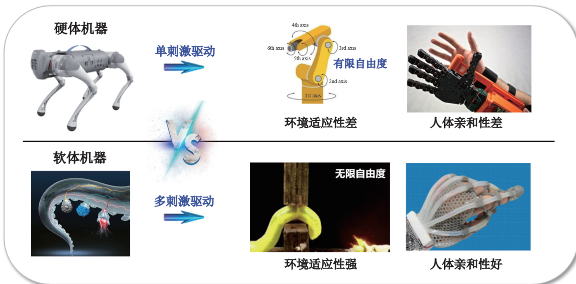
图1 硬体机器人和软体机器人的差异
