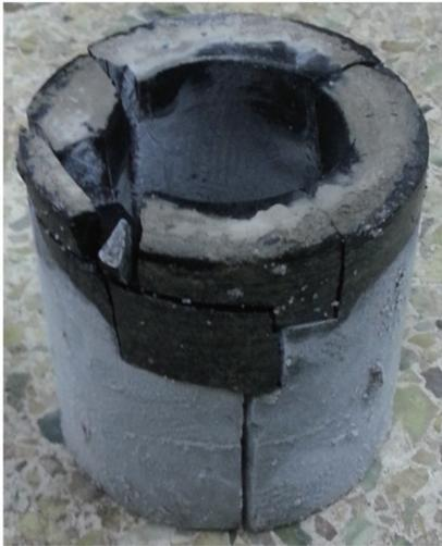
图 15 液氮汽化膨胀作用下的页岩<sup>[27]</sup>
