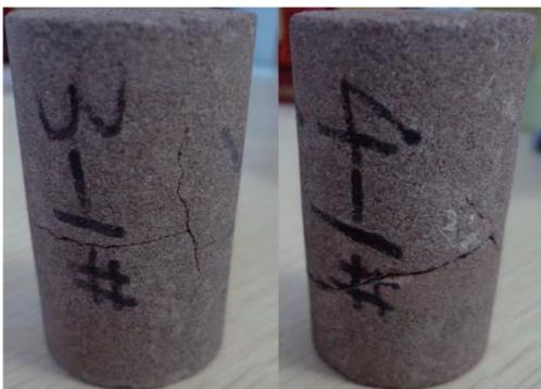
图8 液氮冷却饱水砂岩<sup>[21]</sup>
