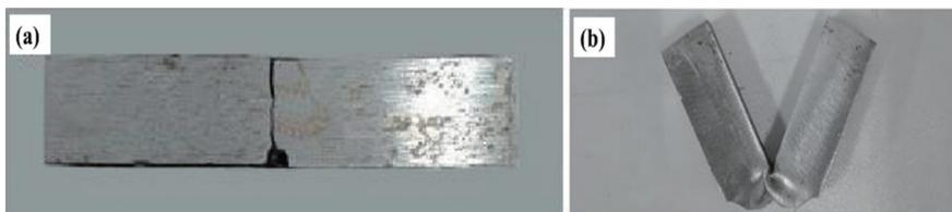
图3 液氮低温下(a)及回复室温后(b)的试件冲击破坏断口<sup>[12]</sup>
